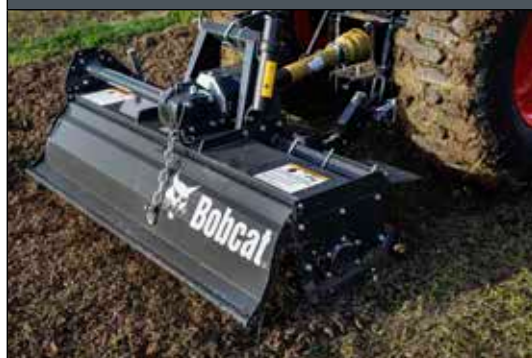
Cultivateur rotatif : prise de force arrière 540 tr/min.
