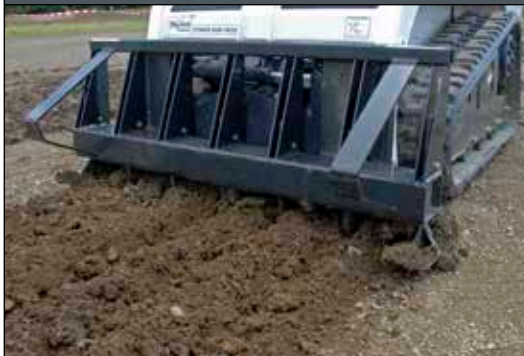
Scarificateur : comprend 2 guides de profondeur et 5 dents.
