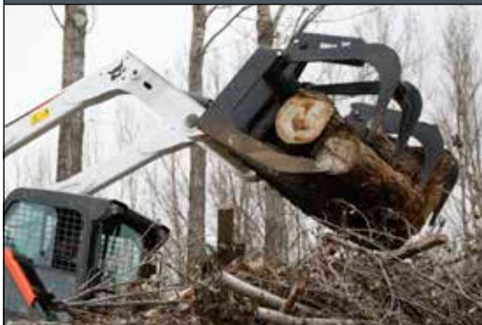
Grappin à déraciner : Il est recommandé d'utiliser un clapet de sécurité secondaire.
