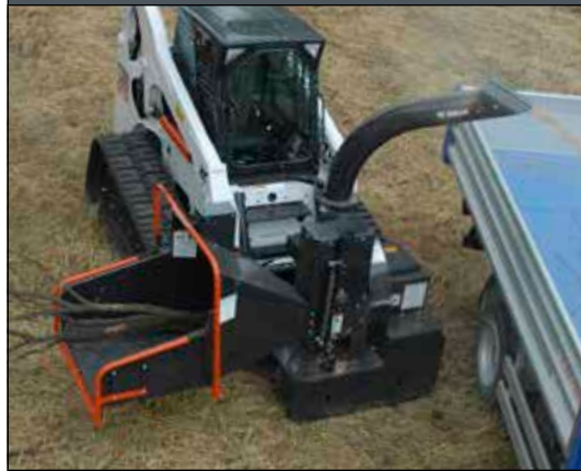
Broyeuse de branches : la chargeuse doit être équipée d'un kit de commande des accessoires à 7 broches.
