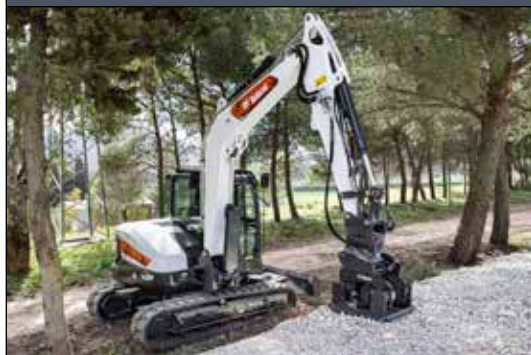
Plaque de compactage : kit de flexibles + platine de fixation + plaque de compactage
