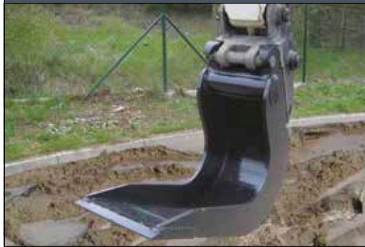
Godets à glaise : le type de raccords dépend du système d'attache.
