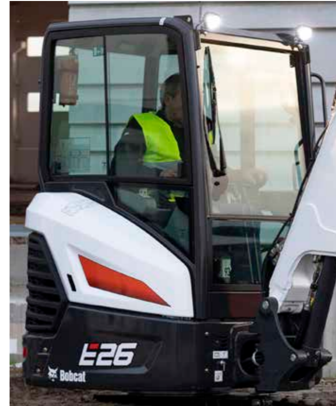
Cabine TOPS / ROPS / FOPS avec chauffage
