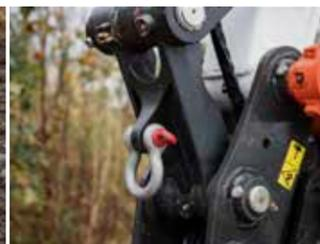
Attache à verrouillage sur axe
