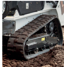
Chenilles en caoutchouc de 400 mm
