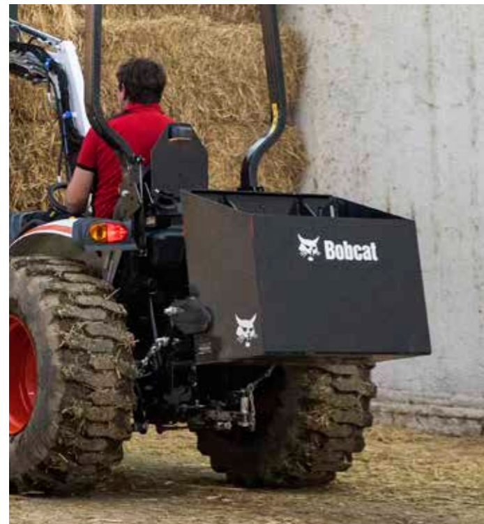
Caisson de lestage
