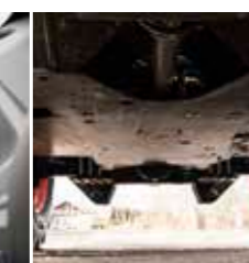
Plaque de protection en acier en partie basse
