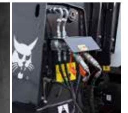
Zusatzhydraulikleitungen am Auslegerkopf mit FCS*
